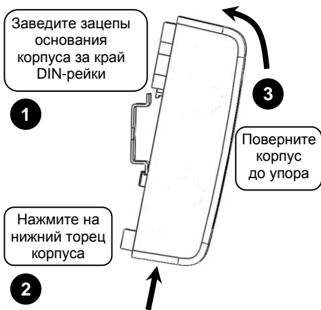
Рисунок 3. Крепление контроллера на DIN-рейку
